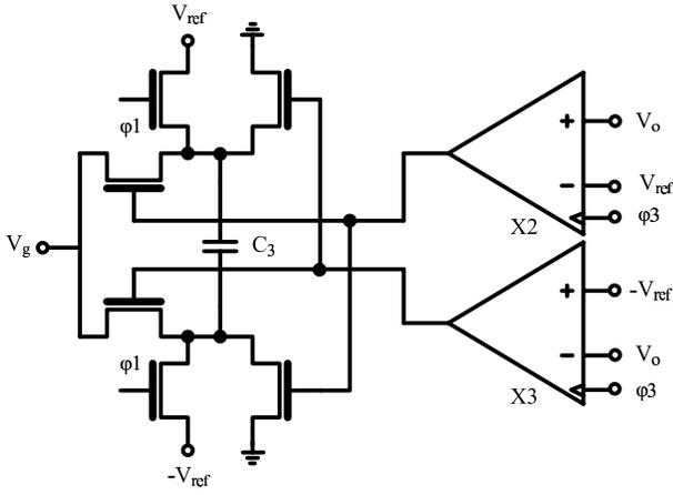
Fig. 10. Modulo circuit
